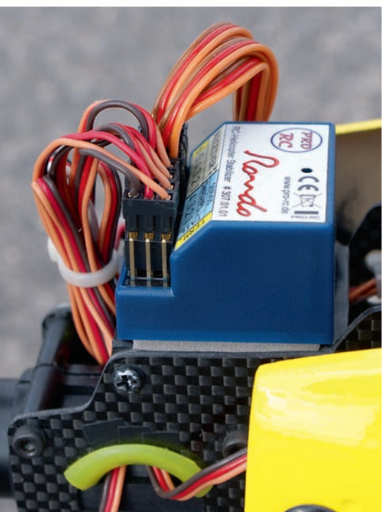
Um das Rondo V2 im Atom 500 unterbringen zu können, mussten die Seitenteile im Bereich der Gyro-Befestigung etwas ausgenommen werden.
