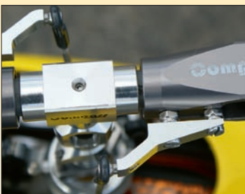
Die Anlenkarme der Blattgriffe wurden mit aufgebohrten Stoppmuttern unterlegt, um die Servokraft und -auflösung besser nutzen zu können.
