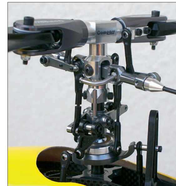
Für die Mitnahme der Taumelscheibe sorgt der modifizierte Pitchkompensator.
